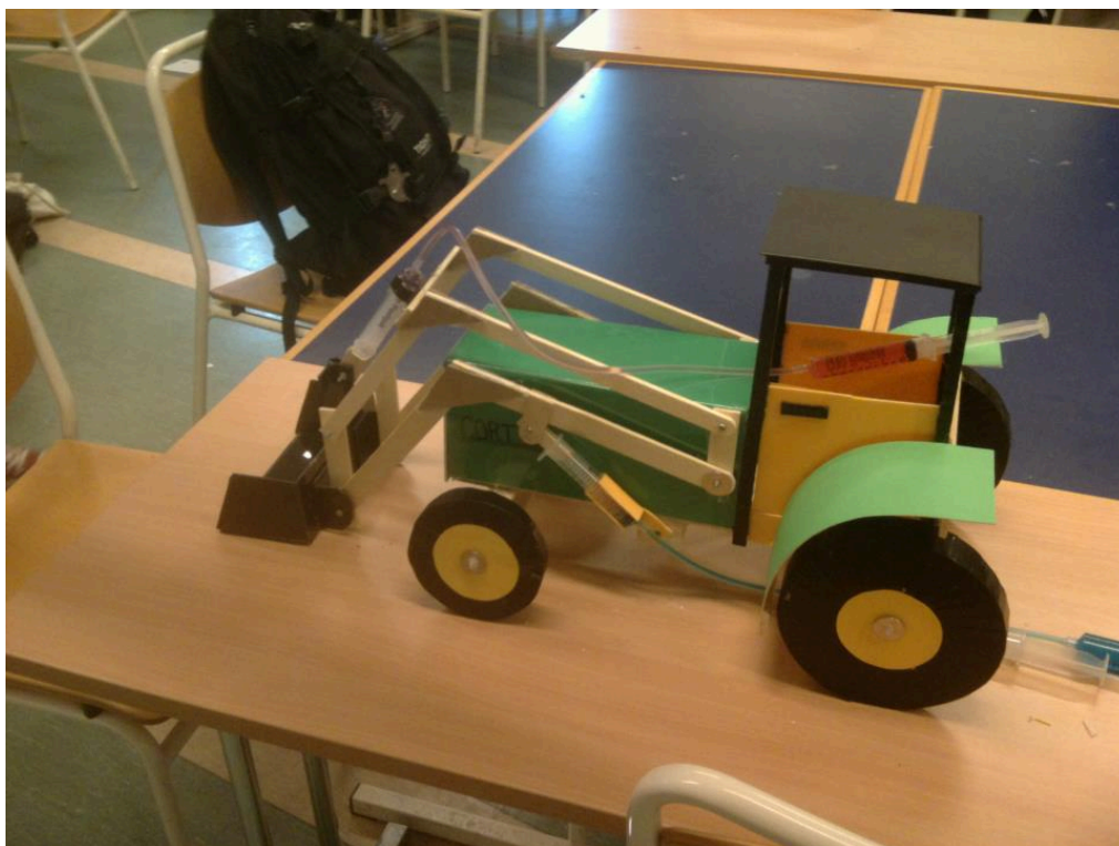
Figur 4. Traktor med skuffe med vinklet vektstang og to hydrauliske systemer.
